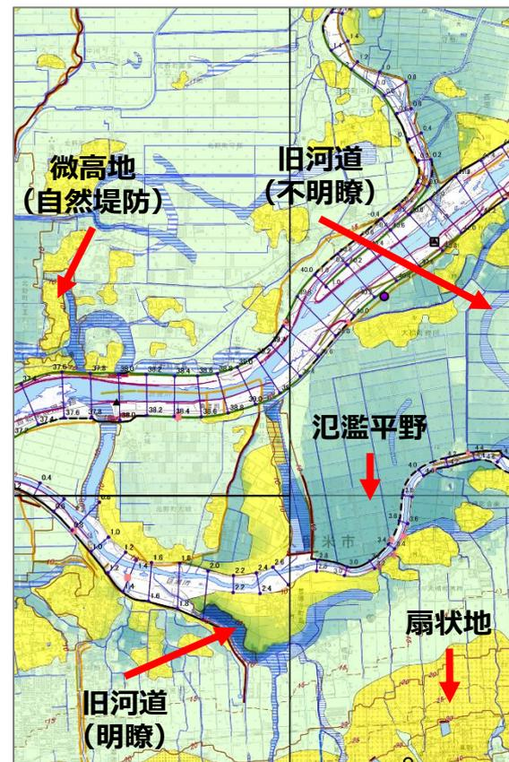
図3 治水地形分類図と令和5年6月29日からの大雨による浸水推定図との重ね合わせ
